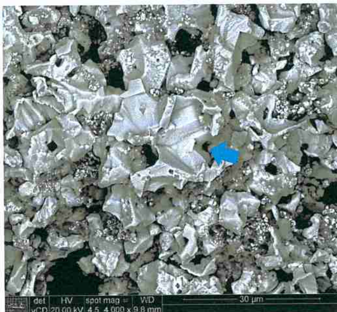
Figura 34 - MEV da amostra G1.2 com aumento de 4000x. Destaque para estrutura de macia observada na região reduzida, após ataque com ácido nítrico 30%
