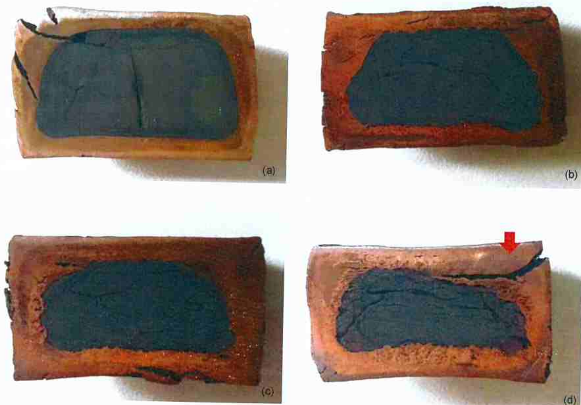
Figura 26 - Fotografias do corte perpendicular realizado nas amostras após exposição ao forno. (a) amostra G1.1 – 35 minutos no forno; (b) amostra G1.2 – 50 minutos no forno; (c) amostra G1.3 – 65 minutos no forno; (d) amostra G1.4 – 80 minutos no forno. Destaque para a trinca na amostra G1.4 que apresenta característica de ter sido formada durante a redução
