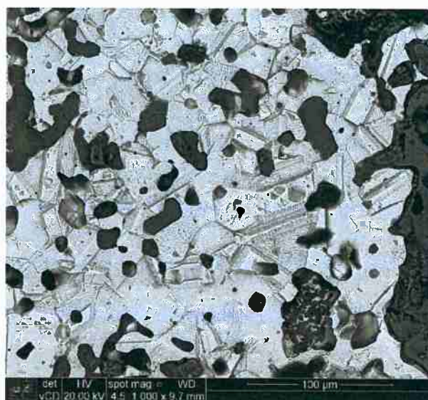
Figura 43 - MEV da amostra G2.1 com aumento de 1000x, após ataque com ácido nítrico 30%
